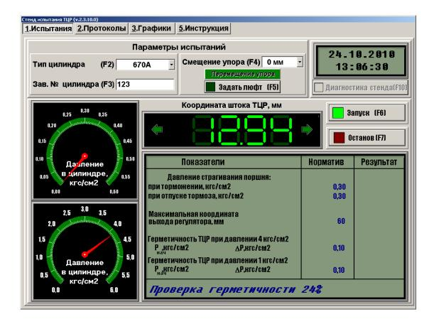
После испытания на герметичность, определяется давление страгивания поршня
