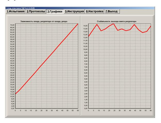
При нормальной работе регулятора на левом графике должна быть прямая линия без изломов. На правом графике изображается поддержание постоянного зазора между штоком цилиндра (тормозными колодками) и колесом.
