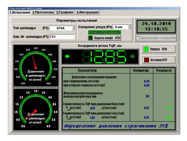
После определения давления страгивания поршня, идет проверка работы регулятора
