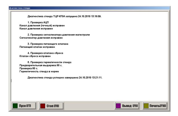
В автоматическом режиме будет произведена диагностика стенда. Но перед этой операцией необходимо на трубку подающую воздух в ТЦР надеть специальную заглушку с манометром и запустить диагностику.
