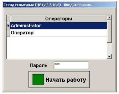
Оператор должен найти свою фамилию в списке пользователей, или администратор должен ввести свой его пароль. После этого нажать на кнопку «Начать работу», при этом нужно проконтролировать положение регулятора ТЦР и если он выдвинут, то привести ТЦР в исходное положение, полностью закрутив винт регулятора ТЦР.
